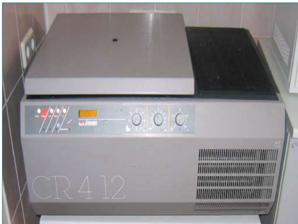
Настольная антиаэрозольная центрифуга с бакет-ротором
