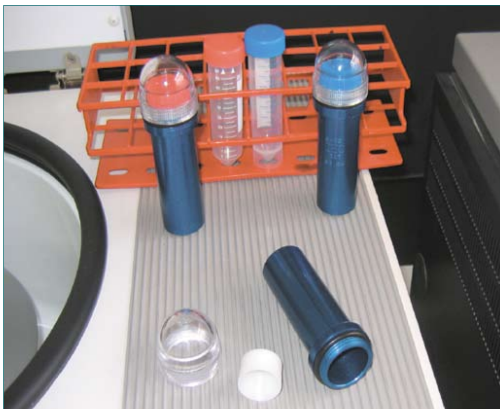
Рис. 9 Индивидуальные центрифужные стаканы для каждого из гнезд углового ротора; подходят для разного типа пробирок (в стакане имеется адаптер для конических пробирок, пробирки с «юбочкой» вставляются в стакан без адаптера)
