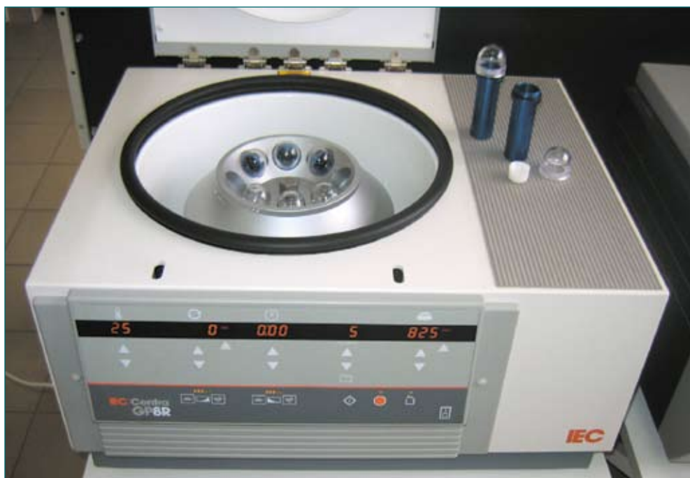
Рис. 8 Настольная антиаэрозольная центрифуга с угловым ротором
