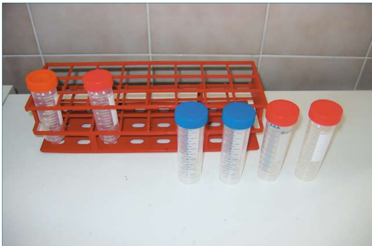
Различные модели центрифужных пробирок объемом 50 мл и пластиковый автоклавируемый штатив для конических пробирок
